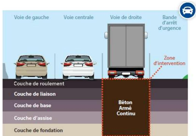
*\*Le Béton Armé Continu est une chaussée en béton renforcé par des armatures permettant de limiter et de répartir la fissuration. En cas de dégradation, ce type de chaussée entraîne des réparations lourdes. Sur le réseau, la plupart des sections ont été remplacées par une structure bitumeuse.*
