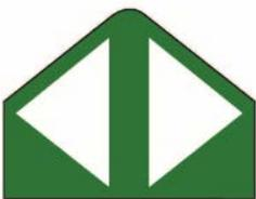
Les atténuateurs de choc visent à améliorer la sécurité des conducteurs qui viendraient à dévier leurs trajectoires. Ce dispositif, marqué d'une flèche de déviation, permet d'atténuer le choc entre un véhicule léger et la glissière en béton située dans la bretelle de sortie.
