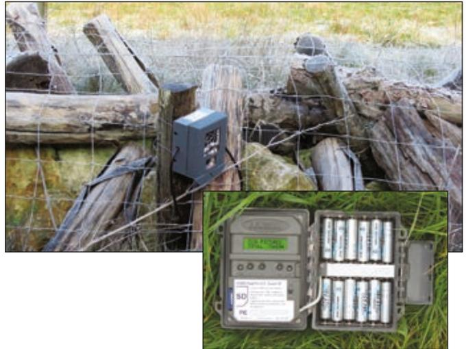
Photos n°2 : **Piège-photo compact et performant utilisé depuis 2011.** (© VINCI Autoroutes, LPO France)
