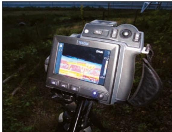
Photo n°24 : **Caméra thermique orientée vers un chiroduc.**
