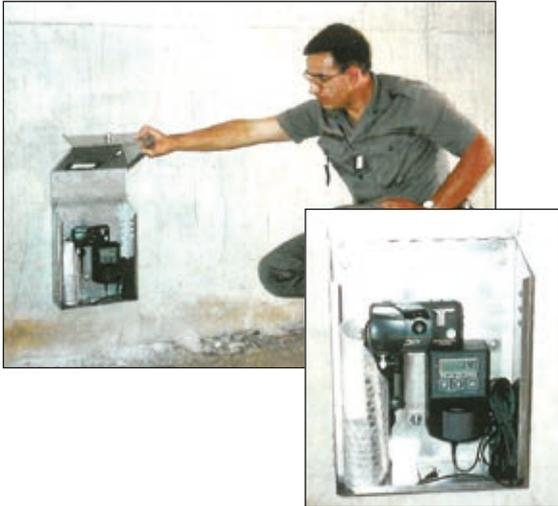
Photos n°1 : **Piège-photo argentique utilisé dans les années 1990.** (© VINCI Autoroutes, OGE)
