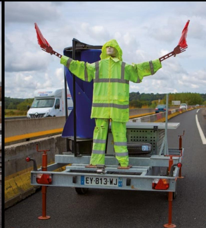
MARTIN, le « Mannequin Autonome de Rappel des Travaux Innovant et Nomade » contribue à la sécurité des chantiers réalisés sous exploitation de l'autoroute.
